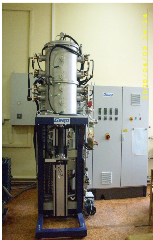
Fig. 2. Instalația Bridgman, Laboratorul de Creșterea Cristalelor, Univ. de Vest Timișoara.
