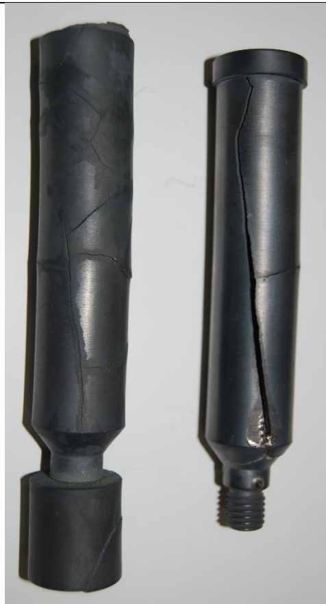
Fig. 10. Distrugerea creuzetului cu grosimea de 2,5 mm în timpul procesului de creștere.
