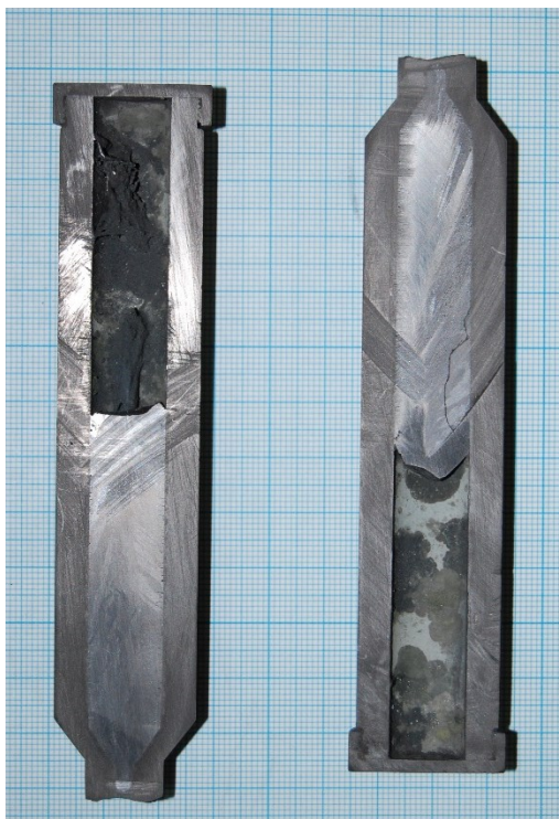
Fig. 9. Aderența siliciu policristalin / creuzet grafit.
